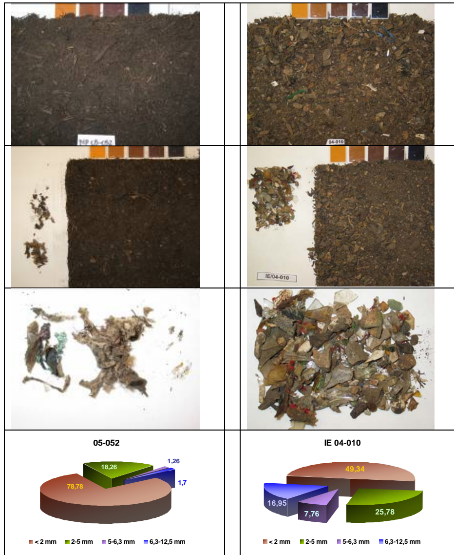
Figura 10.- Aspecto, granulometría y contenido en impropios de dos muestras de RM
